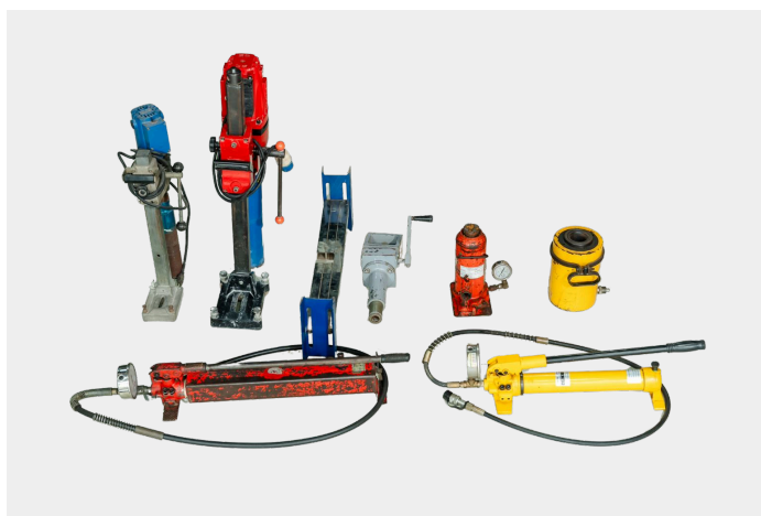
Kích Thủy Lực, Khoan, Bộ CBR Hiện Trường Hydraulic Jack, Drill, And Field CBR Test Set
