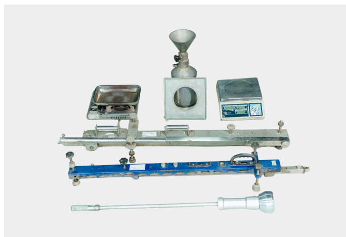
Thiết Bị Đo K (Dao Vòng + Rót Cát), Đo E K-Value Testing Equipment (Core Cutter & Sand Cone) And E-Modulus Testing Equipment
