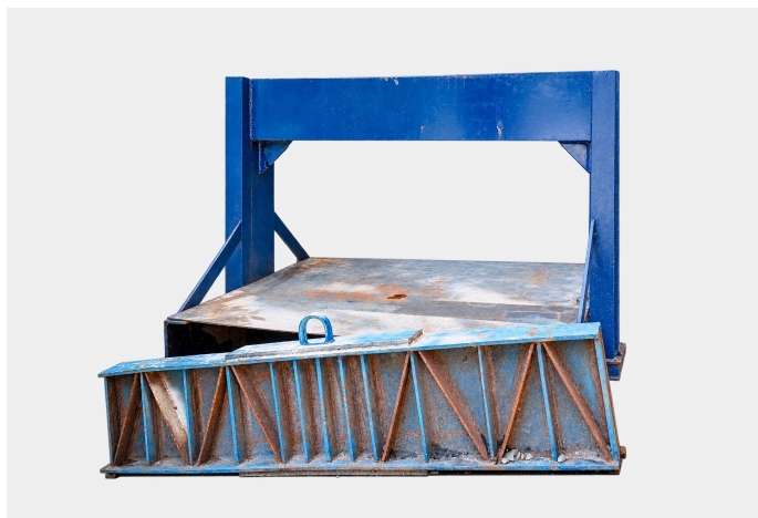
Khu Thử Tải Nắp Hố Ga Manhole Cover Load Testing Area
