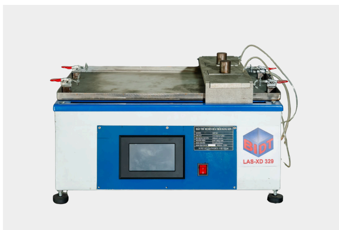
Thiết Bị Rửa Trôi Màng Sơn Paint Film Washout Tester
